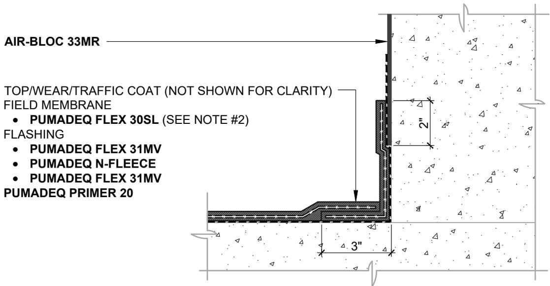
**AIR BARRIER INSTALLED BEFORE PUMADEC SYSTEM**
